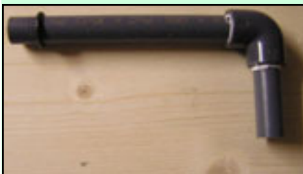
Einen O-Ring auf das Rohr rollen...
