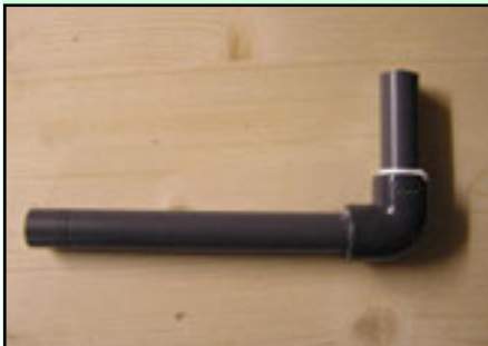
Die Rohrstücke unter leichtem Drehen bis zum Anschlag in das Winkelstück drehen.
