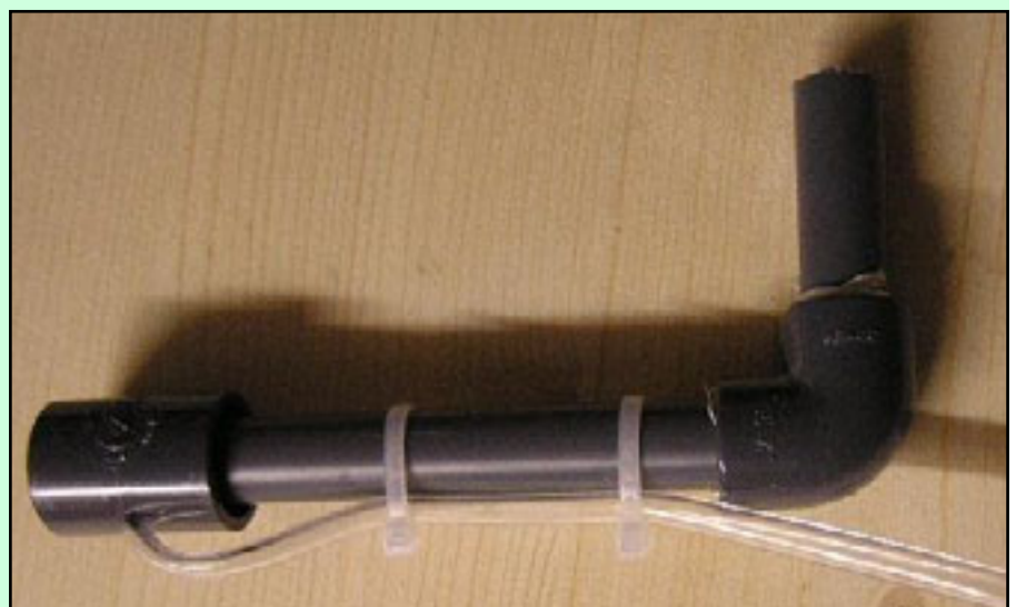
Fertig ist der günstige Luftheber zum Selbstbaupreis!
